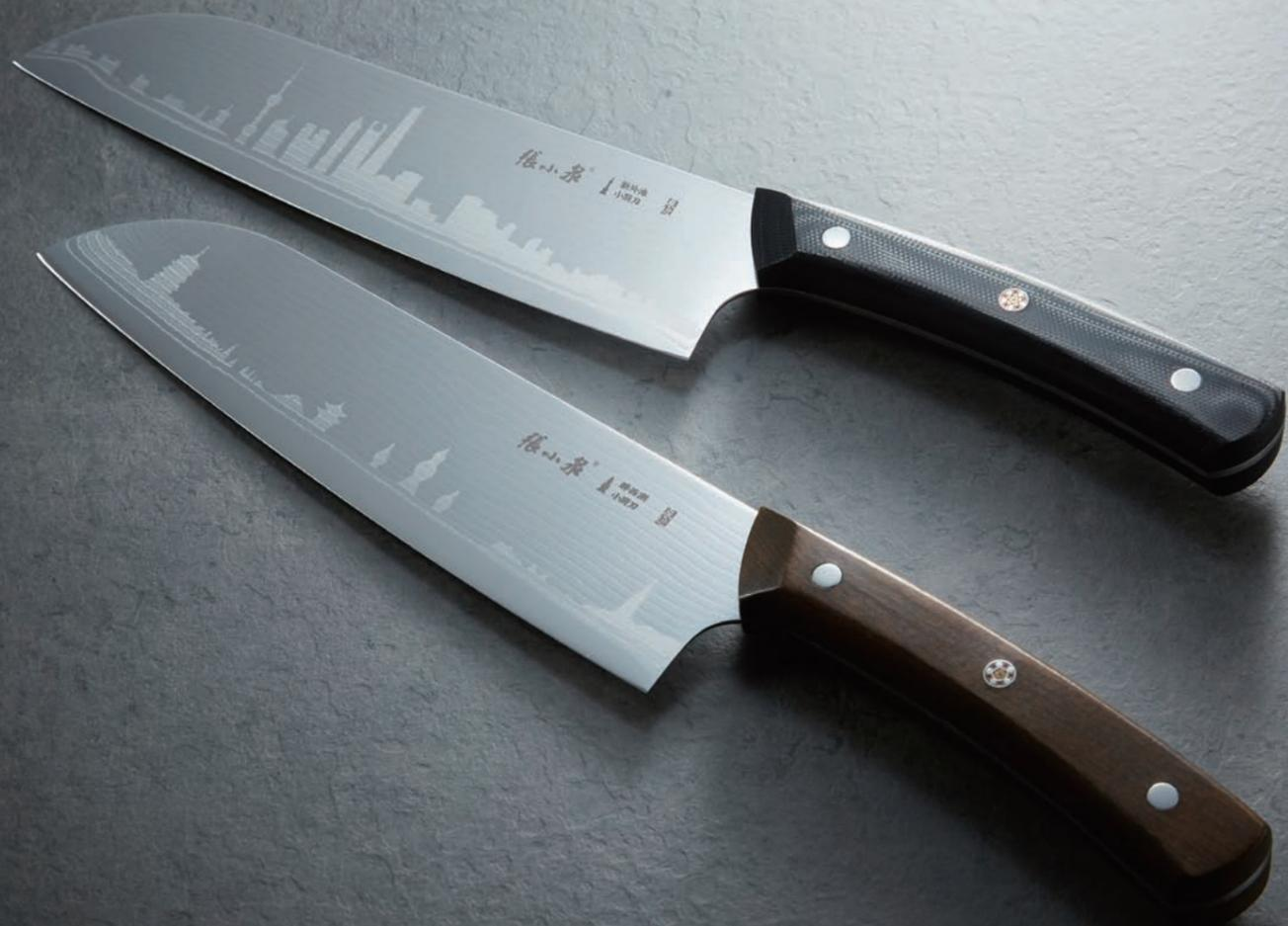
刀具的热处理工艺是整个制刀过程中十分关键的工序,影响着刀具的硬度和韧性。为了找到两者兼备的最佳平衡点,开发人员对钢材进行了反复试验,仔细将热处理后的材料进行金相组织化验,最终确定了淬火、回火的次数、温度和时间,并将深冷温度工艺标准化,最后制定出了完整可行的热处理工艺流程,保证钢材能够满足设计要求。经过高温淬火和深冷冰锻——火与冰的热处理工艺后,钢材性能达到平衡。经检测,该系列刀具刃口硬度达到HRC60以上。
