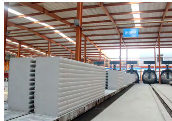
刚出釜的 AAC 板材
